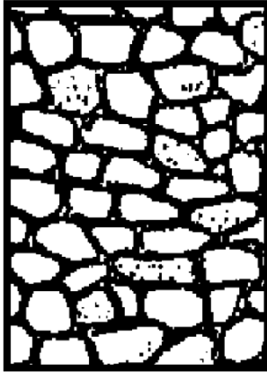
Figure I.4 : Principe de L'opus incertum [2]
